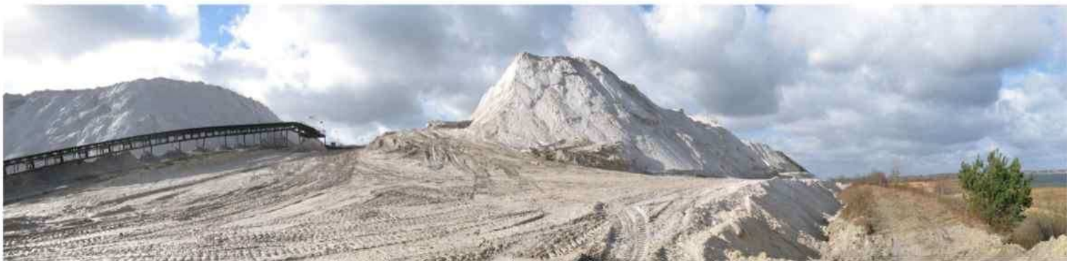
Hałdy fosfogipsów w Wiślince należące do Gdańskich Zakładów Nawozów Fosforowych zajmują 36 hektarów, a ich wysokość sięga 49 metrów
